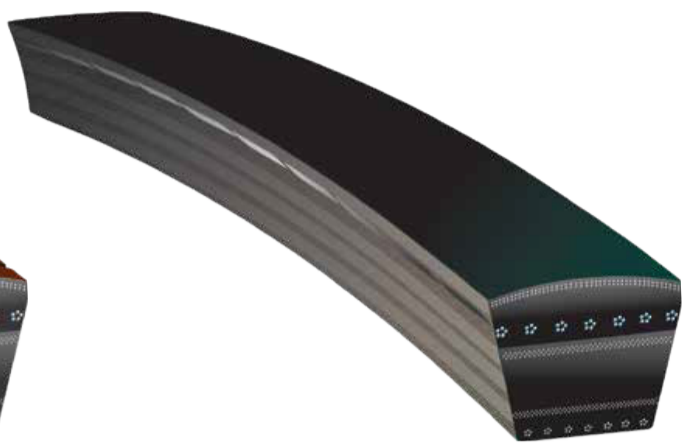
2. DESGASTE EN PAREDES LATERALES.
